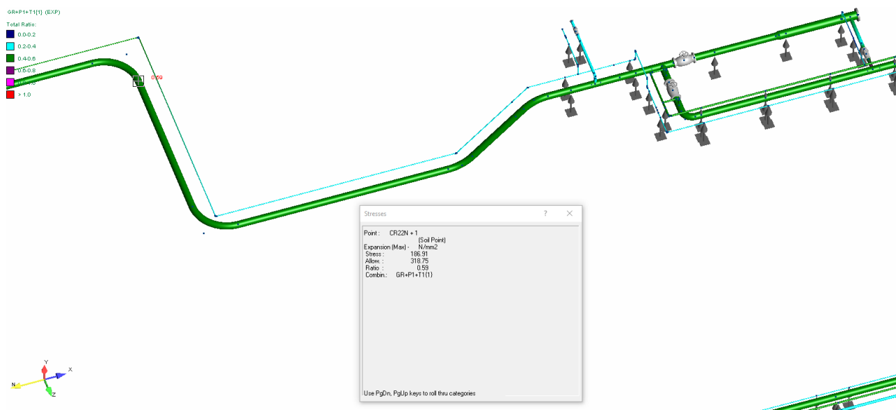
Рисунок 2 – Картина распределения напряжений по Мизесу трубопроводов обвязки узла запуска СОД
